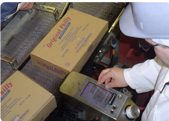
Der Touchscreen des 2300 von Videojet, in den die Daten bereits geladen sind, ermöglicht einfache Wechsel.
